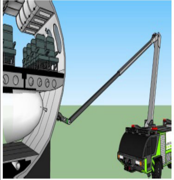
Şekil 11 Uzatmalı Çatı Monitörü yolcu bölümü kullanımı-2 [12]
